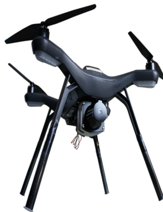
Kuva: 3DR Solo -robottikopterin lentoaika Sick-TiM laserkeilaimen sekä kameran kanssa on noin 10-15 minuuttia - linjaa voidaan tarkastaa jopa 4 km yhdellä edestakaisella lennolla. Solon lentoonlähtöpaino on noin 2000g ja energianlähteenä käytetään 14.8V 5200mAh litium-polymeeriakkua.
