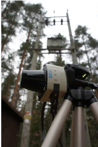
Kuva: Laserkeilainta testattiin voimalinjan alta käsin, ennen keilaimen asentamista robottikopteriin.
